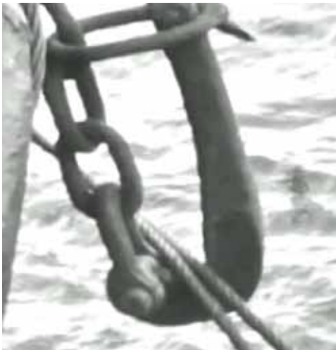
Beide Kurrleinen sind im Sliphaken gesichert.
