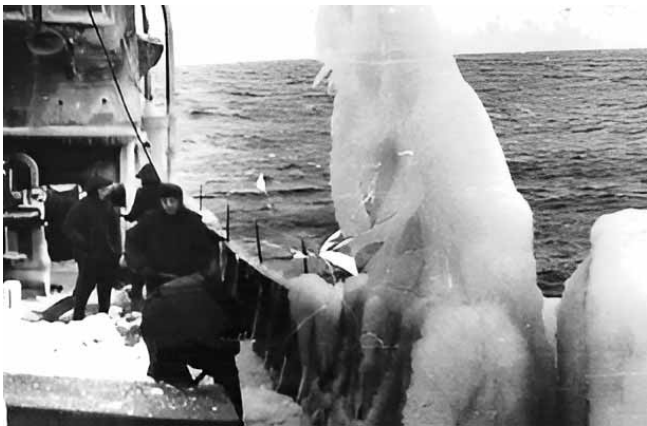
Enteisung des Schiffes durch die Deckslente
